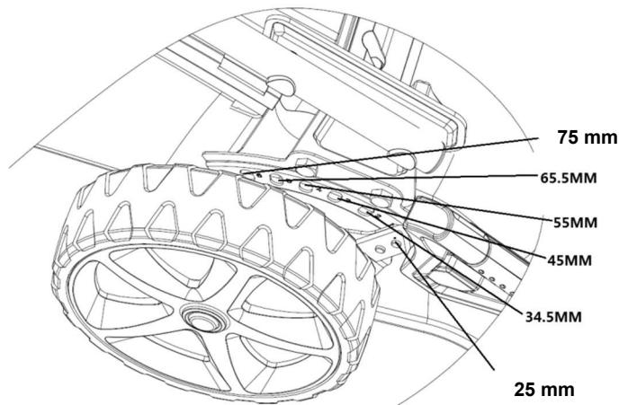
**AVERTISSEMENT** La lame peut causer de graves blessures. Arrêtez le moteur avant de régler la hauteur de coupe.
