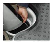
Mettez le fil de signal dans la rainure tube de support pour éviter les dommages
