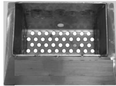
Korf grondig gereinigd met alle openingen in het volle zicht
