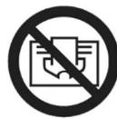
**Ne couvrez pas l'appareil quand il fonctionne pour éviter les risques de surchauffe.**
