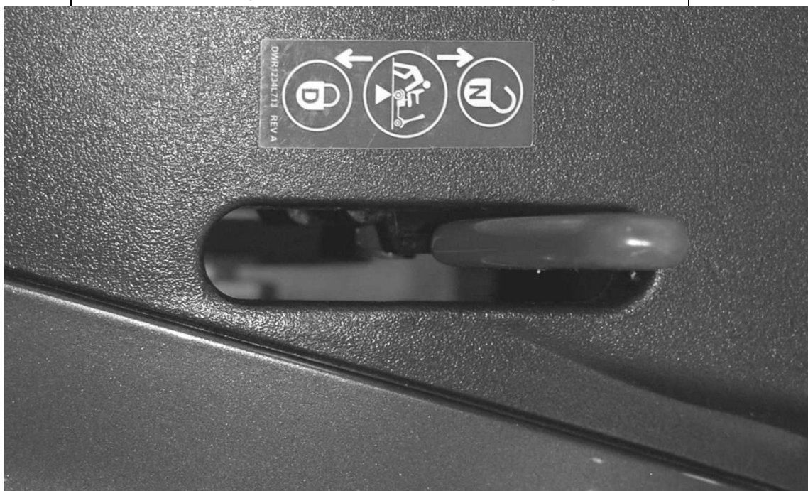
Afbeelding toont hendel in neutrale positie
