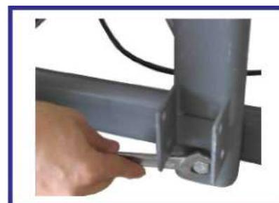
9. Attachez le bas de la plaque de massage sur la plaque inférieure (Comme indiqué sur la Figure 9) (modèle 5 fonctions)
