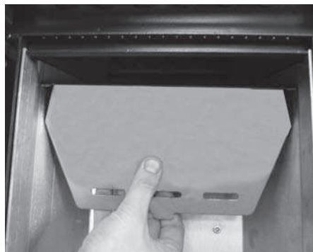
Fig. 16: rotazione del battifiamma
