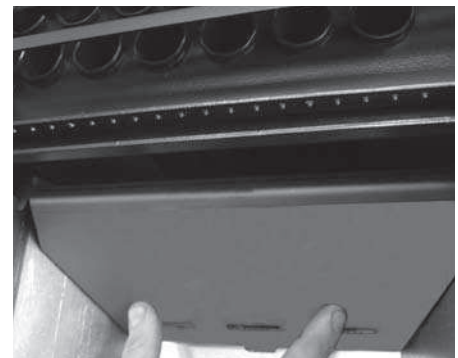
Fig. 14: soulever la plaque coupe-flamme
