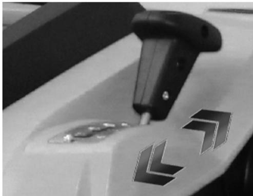
La profondeur du scarificateur est réglée à l'aide du mécanisme de réglage. Tirez le levier de profondeur de scarification dans le sens indiqué par la flèche et ajustez-le à la position souhaitée (1/2/3/4/5). Assurez-vous que le levier s'enclenche correctement.
