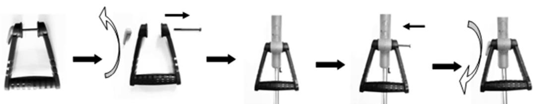
**Réglage en hauteur - Hoogte aanpassing - Height adjustment - Telescopico**
