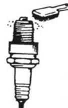
3. Controleren de spreiding van de elektrode (standaard: 0.7 – 0.8 mm).
